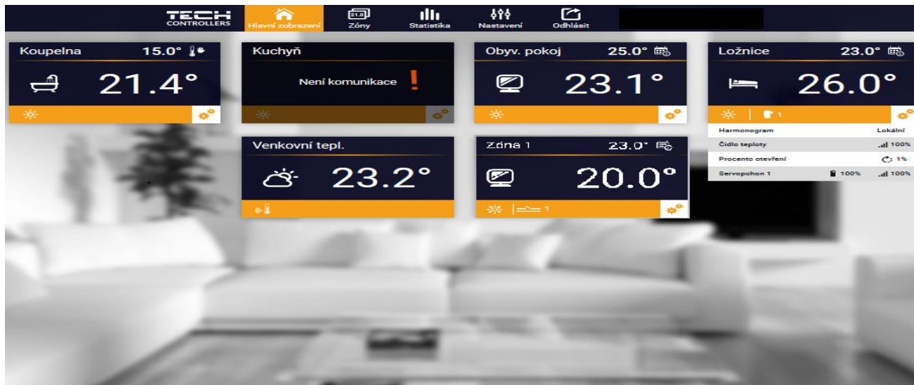
Záložka Hlavní zobrazení (5 aktivních zón, v zóně Ložnice jsou vidět přídavné informace, zóna Kuchyň nekomunikuje)
